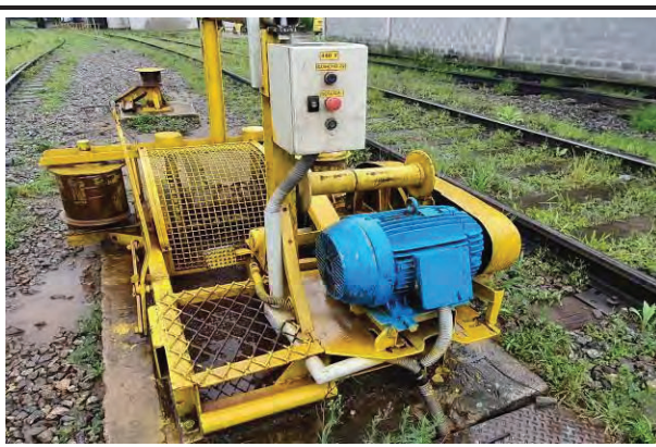
- FMC - MODIFICAÇÕES E RECUPERAÇÃO DOS GUINCHOS DE POSICIONAMENTO DE VAGÕES -
