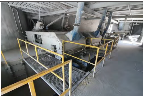
- FMC - BALANÇAS DOSADORAS E49 E E50 E COM MISTURADOR E51 EMBAIXO DAS BALANÇAS RECEBENDO O MATERIAL -
